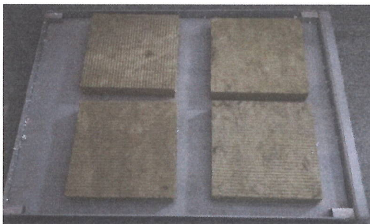
Рисунок 8 – Зволоження дослідних зразків теплоізоляційного матеріалу марки «ТЕХНОРУФ В ОПТИМА»
