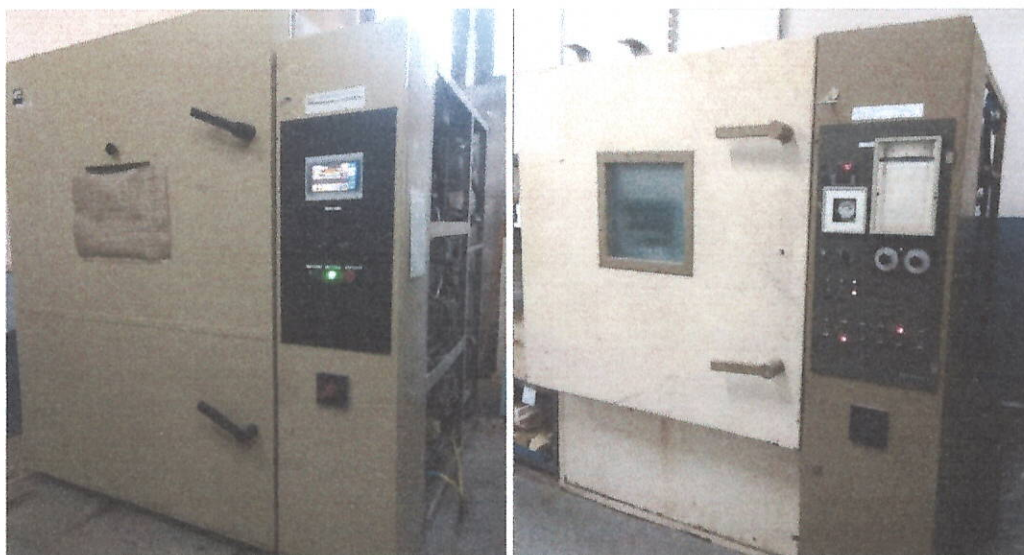
Рисунок 3 – Кліматичні камери для проведення циклічних кліматичних впливів
